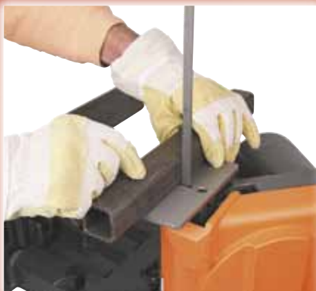
Superficie vertical de corte con extra sujeción, RBX 120 HV + 180 HV
