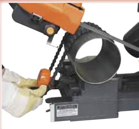
Cambio de la sierra en funcionamiento RBX 180 HV
