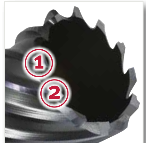
Dentado de alto rendimiento con pre- (1) y post (2) fresado
