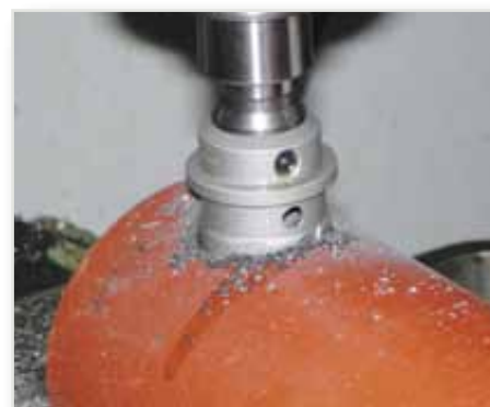
Fresado de tubos
