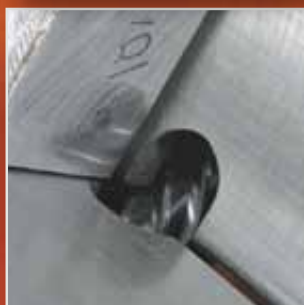
Desbarbado exacto mediante la auto-generación de la fresa
